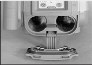
Foto 2 Compartimento de la batería
